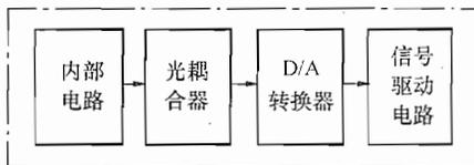
图 14-9-8 模拟量输出模块框图
