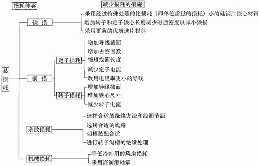
图 2-2-11 减少电动机损耗的措施
