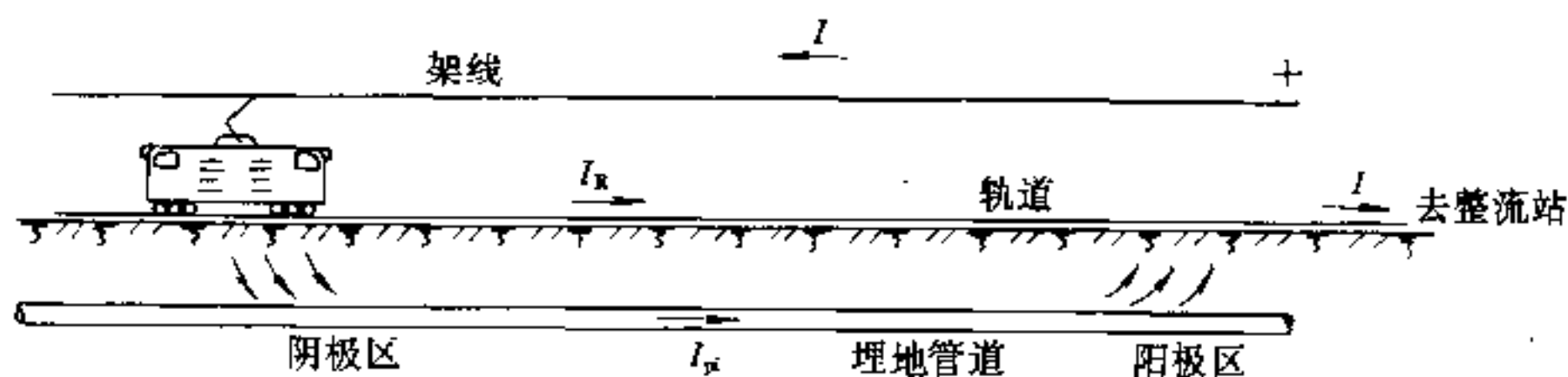
图 34-79 杂散电流对地下管道的影响
