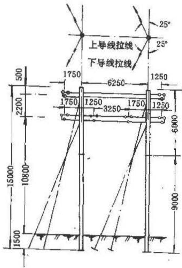
图 21-50 双回路三分裂导线 I 型转角杆塔 上导线拉线对地夹角 \beta=63^\circ ， 下导线拉线对地夹角 \beta=45^\circ
